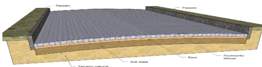
Figura 15 - Desenho esquemático do perfil transversal da pavimentação com blocos de concreto
